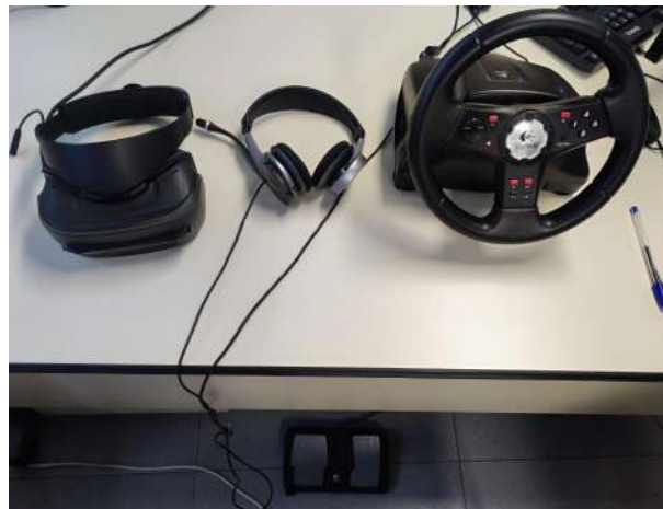
Fig. 5. – Vue d'ensemble du matériel utilisé pour le contrôle du véhicule en VR
